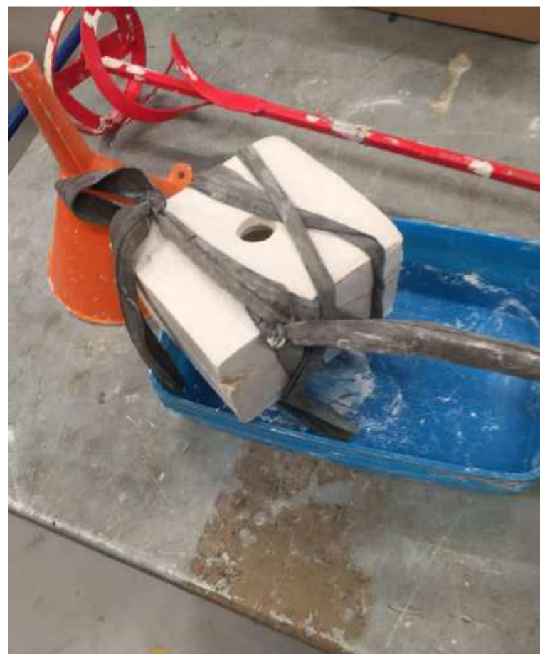
7-ready to pour slip
